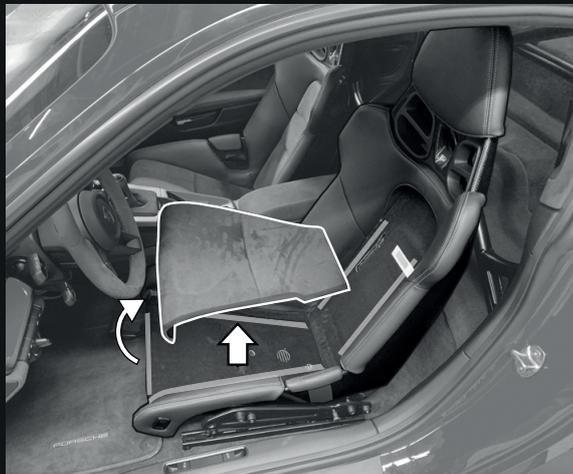
2. Kederleiste nach unten abziehen. Sitzkissen im hinteren Teil greifen, vorsichtig von Klettband lösen und entnehmen.
