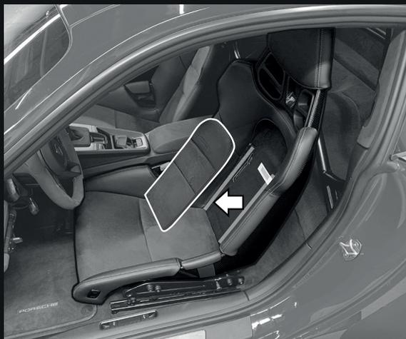
1. Lehnenpolster im unteren Teil greifen, vorsichtig von Klettband lösen und entnehmen.
