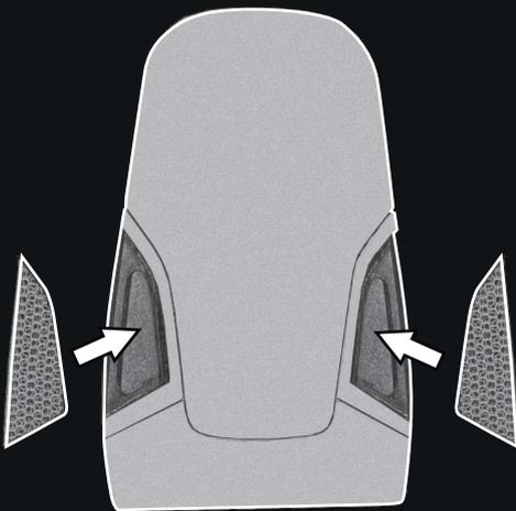
6. Gitterelemente rechts und links vorsichtig in die Aufnahmen an der Trägerplatte des 3D Bodyform Lehnenpolsters einstecken.
